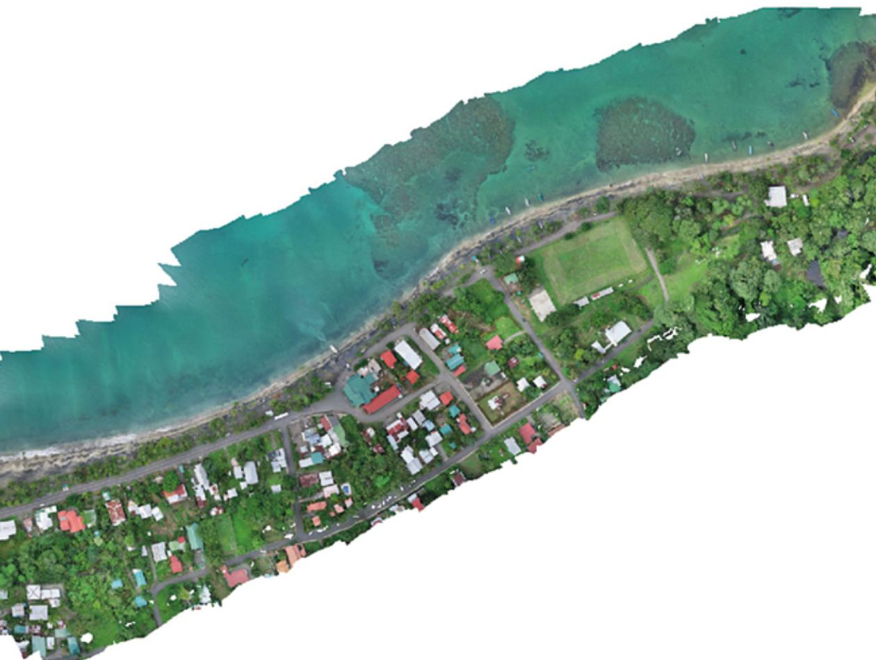
**Figure 8.4.** Photomosaïque obtenue depuis un vol photogrammétrique sur la plage de Gandoca. Ce secteur présente une érosion intense. Il convient de noter la proximité de la plage des infrastructures, telles que les infrastructures urbaines, y compris les installations touristiques (hôtels et restaurants), en raison du recul du trait de côte.
