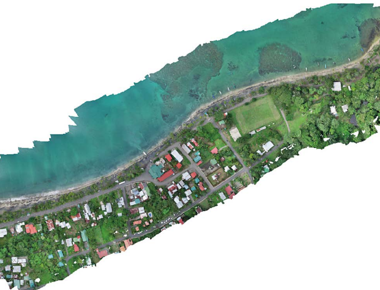
Figure 8.4. Photomosaïque obtenue depuis un vol photogrammétrique sur la plage de Gandoca. Ce secteur présente une érosion intense. Il convient de noter la proximité de la plage des infrastructures, telles que les infrastructures urbaines, y compris les installations touristiques (hôtels et restaurants), en raison du recul du trait de côte.
